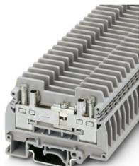
Morsetto sezionatore per conv. misura, con due connettori femmina di prova per spina di prova da 4 mm o per l'alloggiamento di ponticelli trasversali o a vite, tensione nominale: 400 V, corrente nominale: 41 A, tipo di connessione: Connessione a vite, 1. piano, Sezione di dimensionamento: 6 mm<sup>2</sup>, sezione: 0,5 mm<sup>2</sup> - 10 mm<sup>2</sup>, tipo di montaggio: NS 35/7,5, NS 35/15, NS 32, colore: grigio
