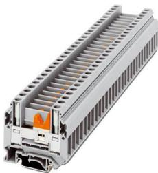
Morsetto sezionatore, tensione nominale: 500 V, corrente nominale: 57 A, tipo di connessione: Connessione a vite, sezione: 0,5 mm<sup>2</sup> - 16 mm<sup>2</sup>, tipo di montaggio: NS 35/7,5, NS 35/15, NS 32, colore: grigio
