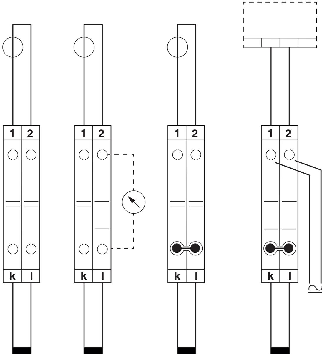
Collegamento di prova convertitore di corrente semplice
