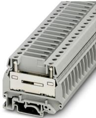
Morsetto trasversale, senza blocchetto scorrevole, tensione nominale: 500 V, corrente nominale: 41 A, numero di connessioni: 2, tipo di connessione: Connessione a vite, 1. piano, Sezione di dimensionamento: 6 mm<sup>2</sup>, sezione: 0,5 mm<sup>2</sup> - 10 mm<sup>2</sup>, tipo di montaggio: NS 35/7,5, NS 35/15, NS 32, colore: grigio
