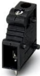
Morsetto per circuiti stampati, corrente nominale: 20 A, tensione di dimensionamento (III/2): 630 V, sezione nominale: 2,5 mm<sup>2</sup>, passo: 7,5 mm, numero poli: 3, collegamento: Connessione a vite con gabbia, montaggio: Saldatura ad onde, direzione di collegamento conduttore/scheda: 0 °, colore: nero, Layout Pin: Piedinatura doppia lineare, Lunghezza pin [P]: 4,82 mm
