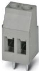
Morsetto per circuiti stampati, corrente nominale: 24 A, tensione di dimensionamento (III/2): 400 V, sezione nominale: 2,5 mm<sup>2</sup>, passo: 5,08 mm, numero poli: 5, collegamento: Connessione a vite con gabbia, montaggio: Saldatura ad onde, direzione di collegamento conduttore/scheda: 0 °, colore: verde biancastro, Layout Pin: Pinning lineare, Lunghezza pin [P]: 3,5 mm
