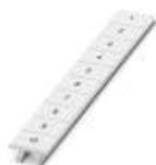
Nastro Zack, Striscia, bianco, siglato, siglabile con: CMS-P1-PLOTTER, siglatura trasversale: numeri progressivi 1 ...10, 11 ...20 ecc. fino a 91 ...100, tipo di montaggio: inserimento a scatto in scanalatura alta portacartellini, per morsetti con spessore: 8,2 mm, dimensioni campo di siglatura: 10,5 x 8,15 mm, Numero dei cartellini singoli: 10
