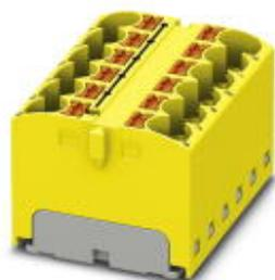
Blocco distributore, ponticellato internamente, I blocchi sono ponticellabili tra di loro sopra il vano conduttori. Per ponticelli a innesto adatti, vedere accessori, tensione nominale: 450 V, corrente nominale: 32 A, collegamento: Connessione Push-in, numero di connessioni: 12, sezione: 0,2 mm<sup>2</sup> - 6 mm<sup>2</sup>, AWG: 24 - 10, larghezza: 36,9 mm, altezza: 22,7 mm, colore: giallo, tipo di montaggio: incollare
