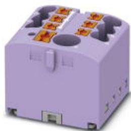
Blocco distributore, Morsetto base con alimentazione, I blocchi sono ponticellabili tra di loro sopra il vano conduttori. Per ponticelli a innesto adatti, vedere accessori, tensione nominale: 450 V, corrente nominale: 24 A, collegamento: Connessione Push-in, Connessione Push-in, numero di connessioni: 7, sezione: 0,14 mm<sup>2</sup> - 4 mm<sup>2</sup>, AWG: 26 - 12, larghezza: 25,6 mm, altezza: 22,7 mm, colore: viola, tipo di montaggio: incollare
