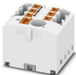
Blocco distributore, Morsetto base con alimentazione, I blocchi sono ponticellabili tra di loro sopra il vano conduttori. Per ponticelli a innesto adatti, vedere accessori, tensione nominale: 450 V, corrente nominale: 24 A, collegamento: Connessione Push-in, Connessione Push-in, numero di connessioni: 7, sezione: 0,14 mm<sup>2</sup> - 4 mm<sup>2</sup>, AWG: 26 - 12, larghezza: 25,6 mm, altezza: 22,7 mm, colore: bianco, tipo di montaggio: incollare
