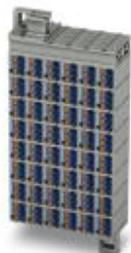
Cabina di smistamento, tensione nominale: 500 V, corrente nominale: 17,5 A, sezione: 0,14 mm<sup>2</sup> - 2,5 mm<sup>2</sup>, AWG: 14 - 26, collegamento: Connessione Push-in, numero poli: 8, numero connessioni: 288, larghezza: 66 mm, lunghezza: 111 mm, colore: grigio, elementi di connessione colore: blu, montaggio: Montaggio a parete, Rack da 19"
