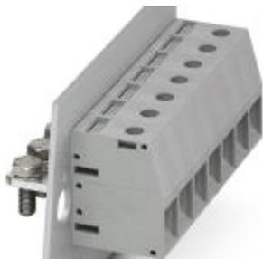
Morsetto passaparete, collegamento: Connessione a vite con gabbia, Attacco capocorda, numero poli: 1, corrente di carico: 150 A, sezione: 16 mm<sup>2</sup> - 50 mm<sup>2</sup>, direzione di connessione del conduttore alla direzione di inserzione: 0 °, colore: grigio
