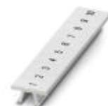
Nastro Zack, Striscia, bianco, siglato, siglatura longitudinale: numeri progressivi 1 ...10, 11 ...20 ecc. fino a 491 ...500, tipo di montaggio: inserimento a scatto in scanalatura alta portacartellini, per morsetti con spessore: 5,2 mm, dimensioni campo di siglatura: 5,15 x 10,5 mm, Numero dei cartellini singoli: 10
