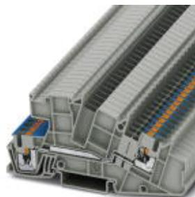
Morsetto per installazioni, Connessione Push-in, sezione: 0,14 mm<sup>2</sup> - 4 mm<sup>2</sup>, AWG: 26 - 12, larghezza: 5,2 mm, colore: grigio/blu, tipo di montaggio: NS 35/7,5, NS 35/15
