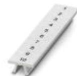
Nastro Zack, bianco, siglatura trasversale: numeri progressivi 1 ...10, 11 ...20 ecc. fino a 491 ...500, tipo di montaggio: inserimento a scatto in scanalatura alta portacartellini, per morsetti con spessore: 5,2 mm, dimensioni campo di siglatura: 5,15 x 10,5 mm
