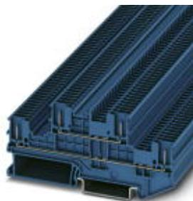
Morsetto a due piani, collegamento: Connessione Push-in, sezione: 0,14 mm<sup>2</sup> - 1,5 mm<sup>2</sup>, AWG: 26 - 14, larghezza: 3,5 mm, colore: blu, tipo di montaggio: NS 35/7,5, NS 35/15
