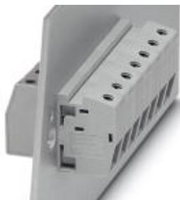
Morsetto passaparete, collegamento: Connessione a vite con gabbia, Connessione a vite con gabbia, numero poli: 1, corrente di carico: 57 A, sezione: 0,5 mm<sup>2</sup> - 16 mm<sup>2</sup>, direzione di connessione del conduttore alla direzione di inserzione: 0°, colore: blu
