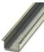
Guida di supporto, non perforata, Profilo standard, larghezza: 35 mm, altezza: 15 mm, simile a norma EN 60715, materiale: Acciaio, zincato, passivato a strato spesso, lunghezza: 2000 mm, colore: color argento
