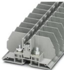
Morsetto di collegamento a bullone, tensione nominale: 800 V, corrente nominale: 125 A, collegamento: Bullone, numero di connessioni: 2, larghezza: 17 mm, altezza: 39,7 mm, colore: grigio, tipo di montaggio: avvitamento diretto
