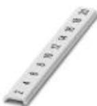
Nastro Zack piatto, Striscia, bianco, siglato, siglatura longitudinale: numeri progressivi 2 ...20, 22 ...40, ecc. fino a 82 ...100, tipo di montaggio: inserimento a scatto in scanalatura piatta portacartellini, per morsetti con spessore: 5 mm, dimensioni campo di siglatura: 5,15 x 5,15 mm, Numero dei cartellini singoli: 10
