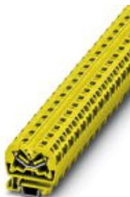
Minimorsetto passante, tensione nominale: 800 V, corrente nominale: 24 A, collegamento: Connessione a molla, numero di connessioni: 4, sezione: 0,08 mm<sup>2</sup> - 4 mm<sup>2</sup>, AWG: 28 - 12, larghezza: 10,4 mm, altezza: 22 mm, colore: giallo, tipo di montaggio: NS 15
