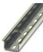
Guida di supporto forata, Profilo standard, larghezza: 35 mm, altezza: 15 mm, simile a norma EN 60715, materiale: Acciaio, zincato, passivato a strato spesso, lunghezza: 2000 mm, colore: color argento
