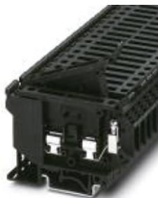
Morsetti portafusibili componibili, tipo di fusibile: Vetro / ceramica / ..., collegamento: Connessione a vite, sezione: 0,2 mm<sup>2</sup>- 4 mm<sup>2</sup>, AWG: 24 - 12, corrente nominale: 6,3 A, tensione nominale: 800 V, larghezza: 8,2 mm, tipo fusibile: G / 5 x 20 / 5 x 25 / 5 x 30, tipo di montaggio: NS 35/7,5, NS 35/15, NS 32, colore: giallo
