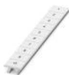
Nastro Zack, Striscia, bianco, siglato, siglabile con: CMS-P1-PLOTTER, siglatura trasversale: numeri progressivi 1 ...10, 11 ...20 ecc. fino a 91 ...100, tipo di montaggio: inserimento a scatto in scanalatura alta portacartellini, per morsetti con spessore: 8,2 mm, dimensioni campo di siglatura: 10,5 x 8,15 mm, Numero dei cartellini singoli: 10
