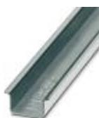
Guida di supporto, non perforata, Profilo standard, larghezza: 35 mm, altezza: 15 mm, simile a norma EN 60715, materiale: Acciaio, zincato, passivato bianco, lunghezza: 2000 mm, colore: color argento
