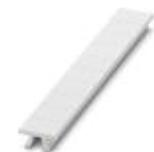
Nastro Zack, ordinabile: a righe, bianco, siglatura custom, tipo di montaggio: inserimento a scatto in scanalatura alta portacartellini, per morsetti con spessore: 8,2 mm, dimensioni campo di siglatura: 10,5 x 8,15 mm, Numero dei cartellini singoli: 10
