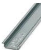
Guida di supporto, non perforata, Profilo standard, larghezza: 35 mm, altezza: 7,5 mm, a norma EN 60715, materiale: alluminio, non rivestito, lunghezza: 2000 mm, colore: color argento
