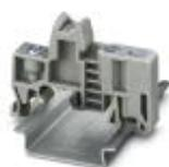
Supporti terminali, larghezza: 9,5 mm, altezza: 35,3 mm, materiale: PA, lunghezza: 50,5 mm, Montaggio su guida di supporto NS32 o NS 35, colore: grigio
