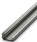
Guida di supporto, non perforata, Profilo G, larghezza: 32 mm, altezza: 15 mm, a norma EN 60715, materiale: Acciaio, zincato, passivato a strato spesso, lunghezza: 2000 mm, colore: color argento
