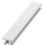
Nastro Zack, Striscia, bianco, in bianco, siglabile con: CMS-P1-PLOTTER, PLOTMARK, tipo di montaggio: inserimento a scatto in scanalatura alta portacartellini, per morsetti con spessore: 8,2 mm, dimensioni campo di siglatura: 10,5 x 8,15 mm, Numero dei cartellini singoli: 10
