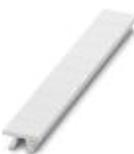
Nastro Zack, Striscia, bianco, in bianco, siglabile con: CMS-P1-PLOTTER, PLOTMARK, tipo di montaggio: inserimento a scatto in scanalatura alta portacartellini, per morsetti con spessore: 8,2 mm, dimensioni campo di siglatura: 10,5 x 8,15 mm, Numero dei cartellini singoli: 10
