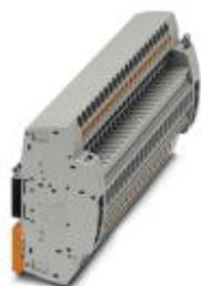
Connettore a innesto di prova, tensione nominale: 400 V AC/DC, collegamento: Connessione Push-in, numero di connessioni: 44, numero poli: 22, sezione: 0,5 mm<sup>2</sup> - 10 mm<sup>2</sup>, AWG: 20 - 8, larghezza: 211,9 mm, altezza: 56,5 mm, colore: grigio, tipo di montaggio: NS 35/7,5, NS 35/7,5
