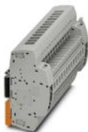
Connettore a innesto di prova, tensione nominale: 400 V AC/DC, collegamento: Connessione a vite, numero di connessioni: 26, numero poli: 13, sezione: 0,2 mm<sup>2</sup> - 10 mm<sup>2</sup>, AWG: 24 - 8, larghezza: 138,6 mm, altezza: 56,5 mm, colore: grigio, tipo di montaggio: Montaggio su guida
