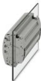
Connettore a innesto di prova, tensione nominale: 400 V AC/DC, collegamento: Connessione a vite, numero di connessioni: 26, numero poli: 13, sezione: 0,2 mm<sup>2</sup> - 10 mm<sup>2</sup>, AWG: 24 - 8, larghezza: 138,6 mm, altezza: 56,5 mm, colore: grigio, tipo di montaggio: Montaggio a parete
