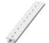
Nastro Zack, Striscia, bianco, siglato, siglabile con: CMS-P1-PLOTTER, siglatura trasversale: numeri progressivi 1 ...10, 11 ...20 ecc. fino a 91 ...100, tipo di montaggio: inserimento a scatto in scanalatura alta portacartellini, per morsetti con spessore: 8,2 mm, dimensioni campo di siglatura: 10,5 x 8,15 mm, Numero dei cartellini singoli: 10
