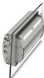
Connettore a innesto di prova, Codifica VDE tipo D19, tensione nominale: 400 V AC/DC, collegamento: Connessione Push-in, numero di connessioni: 38, numero poli: 19, sezione: 0,5 mm<sup>2</sup> - 10 mm<sup>2</sup>, AWG: 20 - 8, larghezza: 188,6 mm, altezza: 56,5 mm, colore: grigio, tipo di montaggio: Montaggio a parete
