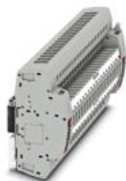
Connettore a innesto di prova, Codifica VDE tipo G19, Uno schema elettrico dettagliato è disponibile alla voce Downloads Varie, tensione nominale: 400 V AC/DC, collegamento: Connessione a vite, numero di connessioni: 38, numero poli: 19, sezione: 0,2 mm<sup>2</sup> - 10 mm<sup>2</sup>, AWG: 24 - 8, larghezza: 187,5 mm, altezza: 56,5 mm, colore: grigio, tipo di montaggio: NS 35/7,5, NS 35/15
