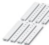
Nastro Zack, Striscia, bianco, siglato, siglabile con: CMS-P1-PLOTTER, siglatura longitudinale: numeri progressivi 1 ...10, 11 ...20 ecc. fino a 91 ...100, tipo di montaggio: inserimento a scatto in scanalatura alta portacartellini, per morsetti con spessore: 8,2 mm, dimensioni campo di siglatura: 10,5 x 8,15 mm, Numero dei cartellini singoli: 10
