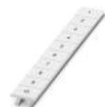
Nastro Zack, Striscia, bianco, siglato, siglabile con: CMS-P1-PLOTTER, siglatura trasversale: numeri progressivi 1 ...10, 11 ...20 ecc. fino a 91 ...100, tipo di montaggio: inserimento a scatto in scanalatura alta portacartellini, per morsetti con spessore: 8,2 mm, dimensioni campo di siglatura: 10,5 x 8,15 mm, Numero dei cartellini singoli: 10
