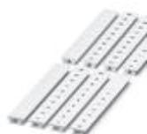
Segnamorsetti, Striscia, bianco, siglato, siglabile con: CMS-P1-PLOTTER, longitudinale: L1, L2, L3, N, PE, L1, L2, L3, N, PE, tipo di montaggio: inserimento a scatto in scanalatura alta portacartellini, per morsetti con spessore: 8,2 mm, dimensioni campo di siglatura: 10,5 x 8,15 mm, Numero dei cartellini singoli: 10
