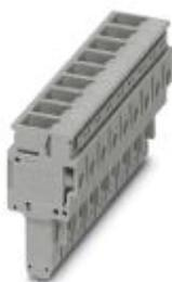
Maschio, numero poli: 9, collegamento: Connessione a vite, sezione: 0,2 mm<sup>2</sup>- 6 mm<sup>2</sup>, AWG: 24 - 8, corrente nominale: 41 A, tensione nominale: 1000 V, larghezza: 73,8 mm, colore: grigio
