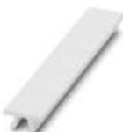
Nastro Zack, Striscia, bianco, in bianco, siglabile con: PLOTMARK, CMS-P1-PLOTTER, tipo di montaggio: inserimento a scatto in scanalatura alta portacartellini, per morsetti con spessore: 13 mm, dimensioni campo di siglatura: 13 x 10,5 mm, Numero dei cartellini singoli: 5
