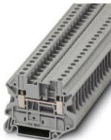
Morsetto passante, tensione nominale: 800 V, corrente nominale: 41 A, collegamento: Connessione a vite, numero di connessioni: 2, numero poli: 1, sezione: 0,14 mm<sup>2</sup> - 6 mm<sup>2</sup>, AWG: 26 - 10, larghezza: 6,2 mm, colore: marrone, tipo di montaggio: NS 35/7,5, NS 35/15
