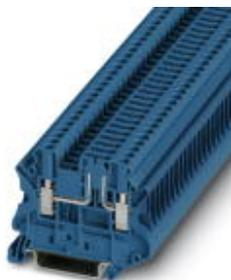
Morsetto sezionatore, con viti per prese di prova per l'alloggiamento di spine di prova, tensione nominale: 400 V, corrente nominale: 20 A, collegamento: Connessione a vite, sezione: 0,14 mm<sup>2</sup> - 4 mm<sup>2</sup>, AWG: 26 - 12, lunghezza: 57,8 mm, larghezza: 5,2 mm, colore: blu, montaggio: NS 35/7,5, NS 35/15
