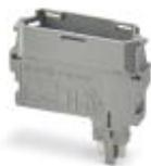
Connettori per componenti, per il montaggio di componenti selezionabili a piacere fino a un diametro di 10 mm e una potenza dissipata max. di 1 W, corrente nominale: 10 A, lunghezza: 41,2 mm, larghezza: 12,3 mm, altezza: 37,5 mm, numero poli: 1, colore: grigio
