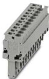
Maschio, numero poli: 11, collegamento: Connessione a molla, sezione: 0,08 mm<sup>2</sup> - 6 mm<sup>2</sup>, AWG: 28 - 10, corrente nominale: 32 A, tensione nominale: 800 V, larghezza: 68,2 mm, colore: grigio
