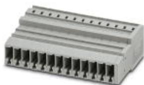
Giunto COMBI, tensione nominale: 800 V, corrente nominale: 32 A, collegamento: Connessione a molla, numero di connessioni: 2, numero poli: 13, sezione: 0,08 mm<sup>2</sup> - 6 mm<sup>2</sup>, AWG: 28 - 10, larghezza: 80,6 mm, altezza: 22,3 mm, colore: grigio
