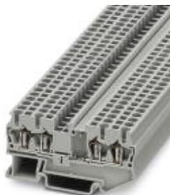
Componente morsetto componibile , per il montaggio di componenti selezionabili a piacere, tensione nominale: 800 V, corrente nominale: 24 A, collegamento: Connessione a molla, numero di connessioni: 4, sezione: 0,08 mm<sup>2</sup> - 4 mm<sup>2</sup>, AWG: 28 - 12, larghezza: 5,2 mm, colore: grigio, tipo di montaggio: NS 35/7,5, NS 35/15
