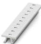
Nastro Zack, Striscia, bianco, siglato, siglabile con: CMS-P1-PLOTTER, siglatura longitudinale: cifre identiche 1 oppure 2 ecc. fino a 100, tipo di montaggio: inserimento a scatto in scanalatura alta portacartellini, per morsetti con spessore: 5,2 mm, dimensioni campo di siglatura: 5,15 x 10,5 mm, Numero dei cartellini singoli: 10
