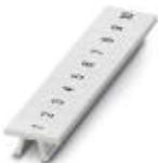
Nastro Zack, Striscia, bianco, siglato, siglatura longitudinale: numeri progressivi 1 ...10, 11 ...20 ecc. fino a 491 ...500, tipo di montaggio: inserimento a scatto in scanalatura alta portacartellini, per morsetti con spessore: 5,2 mm, dimensioni campo di siglatura: 5,15 x 10,5 mm, Numero dei cartellini singoli: 10
