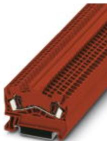
Morsetto passante, tensione nominale: 800 V, corrente nominale: 24 A, collegamento: Connessione a molla, numero di connessioni: 2, sezione: 0,08 mm<sup>2</sup> - 4 mm<sup>2</sup>, AWG: 28 - 12, larghezza: 5,2 mm, colore: rosso, tipo di montaggio: NS 35/7,5, NS 35/15
