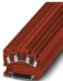
Morsetto passante, tensione nominale: 800 V, corrente nominale: 24 A, collegamento: Connessione a molla, numero di connessioni: 4, sezione: 0,08 mm<sup>2</sup> - 4 mm<sup>2</sup>, AWG: 28 - 12, larghezza: 5,2 mm, colore: rosso, tipo di montaggio: NS 35/7,5, NS 35/15
