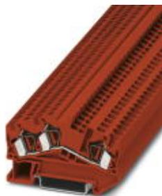
Morsetto passante, tensione nominale: 800 V, corrente nominale: 32 A, collegamento: Connessione a molla, numero di connessioni: 3, sezione: 0,08 mm<sup>2</sup> - 6 mm<sup>2</sup>, AWG: 28 - 10, larghezza: 6,2 mm, colore: rosso, tipo di montaggio: NS 35/7,5, NS 35/15
