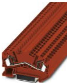
Morsetto passante, tensione nominale: 800 V, corrente nominale: 32 A, collegamento: Connessione a molla, numero di connessioni: 2, sezione: 0,08 mm<sup>2</sup> - 6 mm<sup>2</sup>, AWG: 28 - 10, larghezza: 6,2 mm, colore: rosso, tipo di montaggio: NS 35/7,5, NS 35/15
