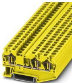
Morsetto passante, tensione nominale: 800 V, corrente nominale: 32 A, collegamento: Connessione a molla, numero di connessioni: 3, sezione: 0,08 mm<sup>2</sup> - 6 mm<sup>2</sup>, AWG: 28 - 10, larghezza: 6,2 mm, colore: giallo, tipo di montaggio: NS 35/7,5, NS 35/15
