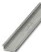
Guida di supporto, non perforata, Profilo standard, larghezza: 35 mm, altezza: 7,5 mm, a norma EN 60715, materiale: Acciaio, zincato, passivato a strato spesso, lunghezza: 2000 mm, colore: color argento
