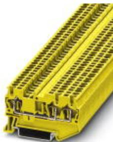
Morsetto passante, tensione nominale: 500 V, corrente nominale: 17,5 A, collegamento: Connessione a molla, numero di connessioni: 3, sezione: 0,08 mm<sup>2</sup> - 1,5 mm<sup>2</sup>, AWG: 28 - 16, larghezza: 4,2 mm, colore: giallo, tipo di montaggio: NS 35/7,5, NS 35/15
