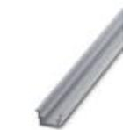
Guida di supporto, non perforata, Profilo standard, larghezza: 35 mm, altezza: 15 mm, simile a norma EN 60715, materiale: alluminio, non rivestito, lunghezza: 2000 mm, colore: color argento
