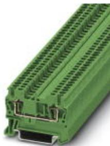
Morsetto passante, tensione nominale: 500 V, corrente nominale: 17,5 A, collegamento: Connessione a molla, numero di connessioni: 2, sezione: 0,08 mm<sup>2</sup> - 1,5 mm<sup>2</sup>, AWG: 28 - 16, larghezza: 4,2 mm, colore: verde, tipo di montaggio: NS 35/7,5, NS 35/15
