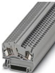
Morsetto sezionatore, tensione nominale: 400 V, corrente nominale: 20 A, collegamento: Connessione a molla, sezione: 0,08 mm<sup>2</sup> - 4 mm<sup>2</sup>, AWG: 28 - 12, lunghezza: 50,8 mm, larghezza: 5,2 mm, colore: grigio, montaggio: NS 35/7,5, NS 35/15
