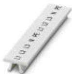
Nastro Zack, Striscia, bianco, siglato, longitudinale: L1, L2, L3, N, PE, L1, L2, L3, N, PE, tipo di montaggio: inserimento a scatto in scanalatura alta portacartellini, per morsetti con spessore: 5,2 mm, dimensioni campo di siglatura: 5,15 x 10,5 mm, Numero dei cartellini singoli: 10
