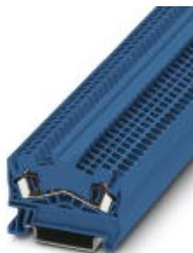
Morsetto passante, tensione nominale: 800 V, corrente nominale: 24 A, collegamento: Connessione a molla, numero di connessioni: 2, sezione: 0,08 mm<sup>2</sup> - 4 mm<sup>2</sup>, AWG: 28 - 12, larghezza: 5,2 mm, colore: blu, tipo di montaggio: NS 35/7,5, NS 35/15
