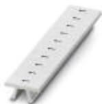
Nastro Zack, Striscia, bianco, siglato, siglabile con: CMS-P1-PLOTTER, siglatura longitudinale: cifre identiche 1 oppure 2 ecc. fino a 100, tipo di montaggio: inserimento a scatto in scanalatura alta portacartellini, per morsetti con spessore: 5,2 mm, dimensioni campo di siglatura: 5,15 x 10,5 mm, Numero dei cartellini singoli: 10
