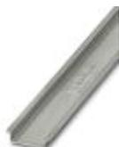
Guida di supporto, non perforata, Profilo standard, larghezza: 35 mm, altezza: 7,5 mm, a norma EN 60715, materiale: Acciaio, zincato, passivato a strato spesso, lunghezza: 2000 mm, colore: color argento
