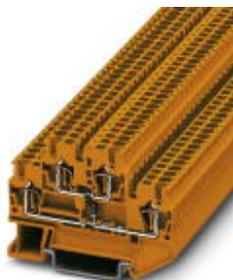
Componente morsetto componibile , tensione nominale: 500 V, corrente nominale: 22 A, collegamento: Connessione a molla, sezione: 0,08 mm<sup>2</sup> - 4 mm<sup>2</sup>, AWG: 28 - 12, lunghezza: 67,5 mm, larghezza: 5,2 mm, colore: arancione, montaggio: NS 35/7,5, NS 35/15
