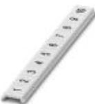
Nastro Zack piatto, Striscia, bianco, siglato, siglatura longitudinale: numeri progressivi 1 ...10, 11 ...20 ecc. fino a 491 ...500, tipo di montaggio: inserimento a scatto in scanalatura piatta portacartellini, per morsetti con spessore: 5 mm, dimensioni campo di siglatura: 5,15 x 5,15 mm, Numero dei cartellini singoli: 10
