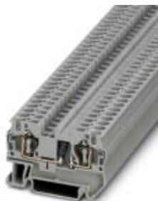
Componente morsetto componibile , con diodo integrato, tensione nominale: 800 V, corrente nominale: 1,5 A, collegamento: Connessione a molla, sezione: 0,08 mm<sup>2</sup> - 6 mm<sup>2</sup>, AWG: 28 - 10, lunghezza: 56 mm, larghezza: 6,2 mm, colore: grigio, montaggio: NS 35/7,5, NS 35/15
