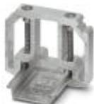
Appoggio terminale, per bloccare morsetti da UKH 50 a UKH 240, viene inserita sulla guida NS 35 e fissata con 2 viti, spessore: 10 mm, colore: alluminio
