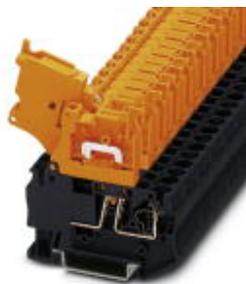
Morsetti sezionatori con leva, tensione nominale: 500 V, corrente nominale: 20 A, collegamento: Connessione a molla, numero di connessioni: 2, sezione: 0,08 mm<sup>2</sup> - 6 mm<sup>2</sup>, AWG: 28 - 10, larghezza: 6,2 mm, colore: blu, tipo di montaggio: NS 35/7,5, NS 35/15
