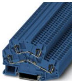
Morsetto a molla a due piani, collegamento: Connessione a molla, sezione: 0,08 mm<sup>2</sup> - 6 mm<sup>2</sup>, AWG: 28 - 10, larghezza: 6,2 mm, colore: blu, tipo di montaggio: NS 35/7,5, NS 35/15
