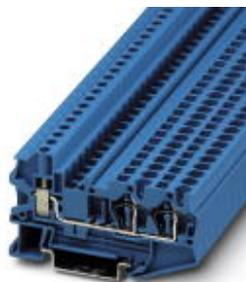
Morsetto passante, collegamento: Connessione a molla, Connessione a vite, sezione: 0,08 mm<sup>2</sup> - 6 mm<sup>2</sup>, AWG: 28 - 10, larghezza: 6,2 mm, colore: blu, montaggio: NS 35/7,5, NS 35/15
