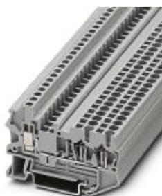
Morsetto passante, collegamento: Connessione a molla, Connessione a vite, sezione: 0,08 mm<sup>2</sup> - 4 mm<sup>2</sup>, AWG: 28 - 14, larghezza: 5,2 mm, colore: grigio, montaggio: NS 35/7,5, NS 35/15
